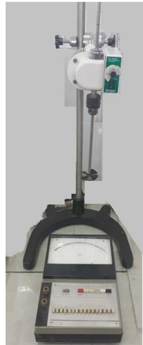
Установка для дослідження процесу перемішування в рідких середовищах
